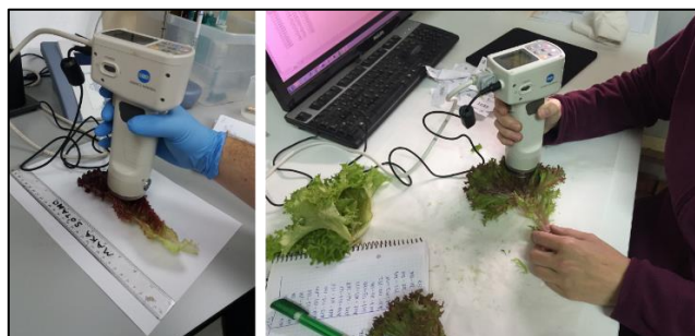
Imagen 3.8. Medición de los parámetros de color en Lollo rosso con colorímetro Minolta CR400.
