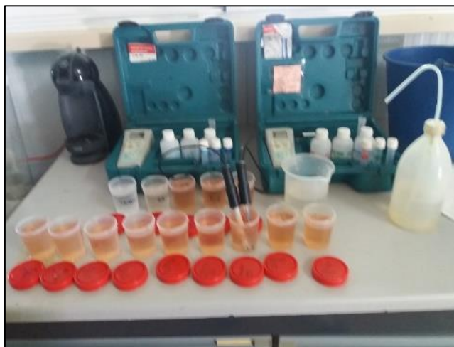
Imagen 3.5. Medición de parámetros de la SN de las cubas de riego.
